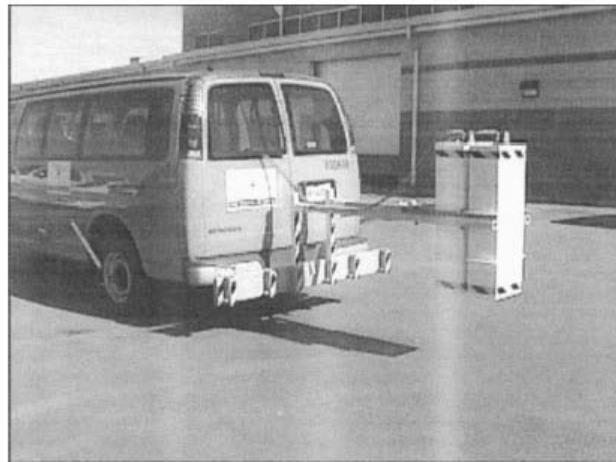
RADAR DE PENETRACIÓN DE TERRENO
